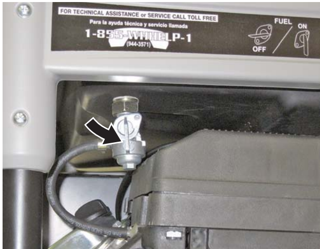
Figura 27 – Válvula de cierre de combustible en la posición ON (encendido)
