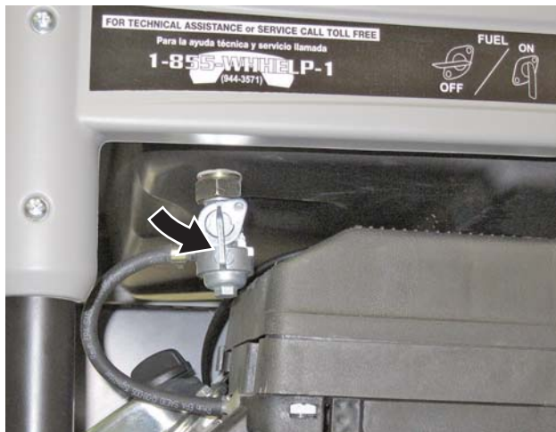
Figura 31 – Válvula de cierre del combustible en la posición ON (encendido)
